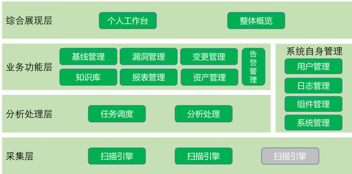
图 4.1 基线核查系统功能架构
